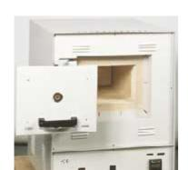
Il Forno a muffola mod. ZB/1 - ZB/2 è normalmente impiegato nel settore meccanico per il trattamento degli acciai, nel settore orafo dentale per la cottura dei rivestimenti, nel settore dell'industria chimica (laboratori), del vetro e della ceramica. Temperatura max.  $1100^{\circ}$  C.
