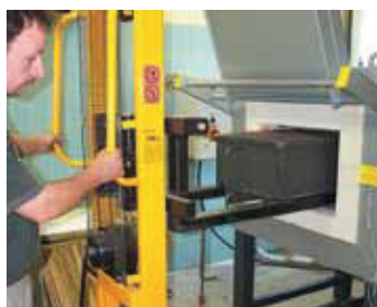
Lavoro con cassetta di cottura per l'atmosfera di gas protettivi mediante l'ausilio di un carrello di carico
