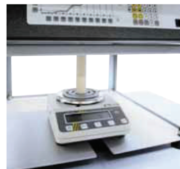
3 bilance di portata massima varia e intervalli di misurazione selezionabili
